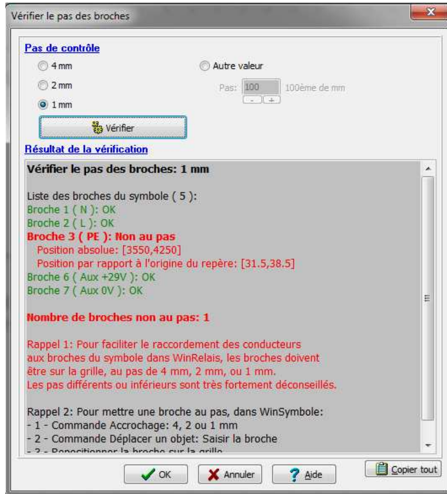
Dialogue Vérifier le pas des broches: Ici, la broche 3 pose problème
